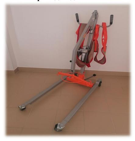
Механическая конструкция подъёмника ТІТАN 9-150 позволяет его эффективное использование в неэлектрифицированных помещениях и в ситуациях с перебоями электропитания. Конструкция винтового домкрата предельно проста и надёжна, требует минимум технического обслуживания и для его многолетней исправной работы достаточно вовремя смазывать винтовой шток домкрата. Конструктивная простота.\*
